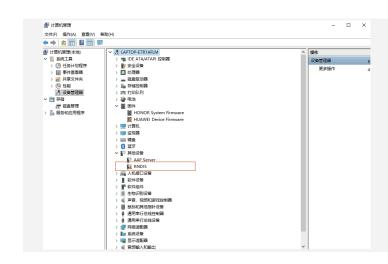
② 右键RNDIS选择更新驱动程序——浏览我的计算机以查找新的驱动程序——让我从计算机上的可用的 驱动列表选取——网络适配器——Microsoft——远程NDIS兼容设备。
