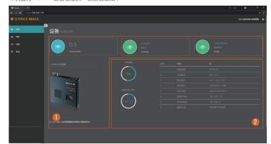
总共有4个页面:设备, 网络, 系统和控制。设备显示的是一些基本信息,如输入的视频源格式、设备名称、固件版本等,您可以实时监控设备的工作状态和运行情况。
